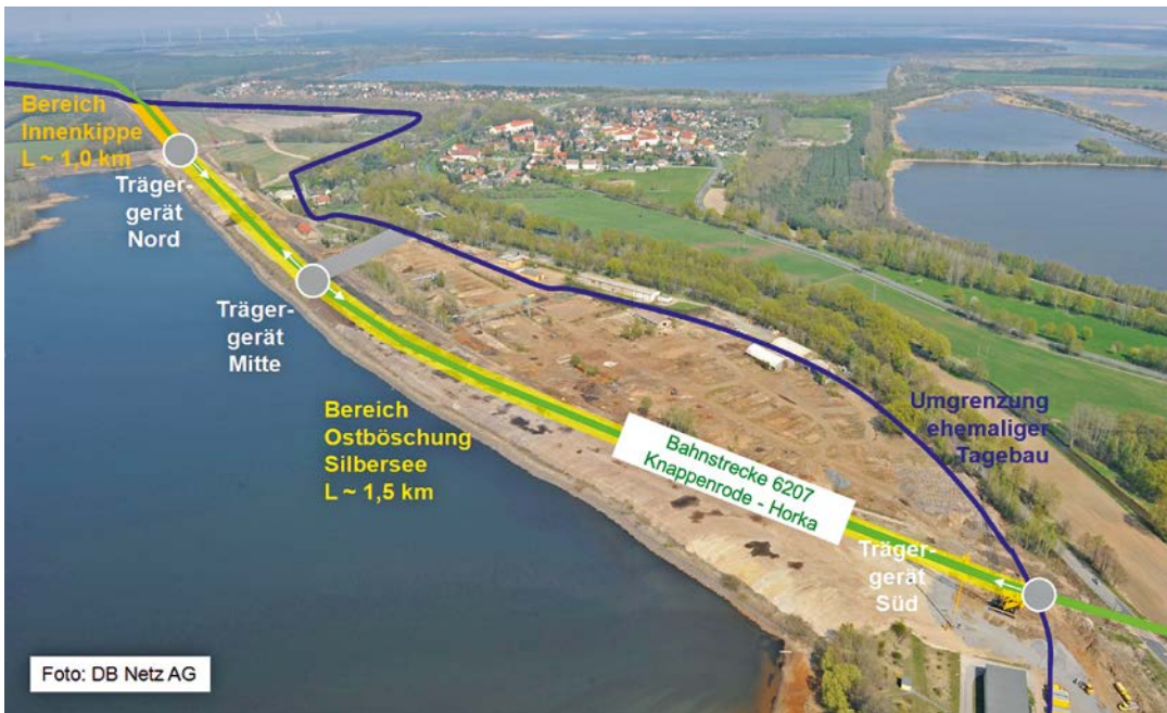
Bild 1. Luftaufnahme des Baubereichs im April 2011 vor Beginn der Tiefenverdichtungsarbeiten [1] Fig. 1. Aerial view of the construction area in April 2011 before the beginning of deep compaction work [1]
